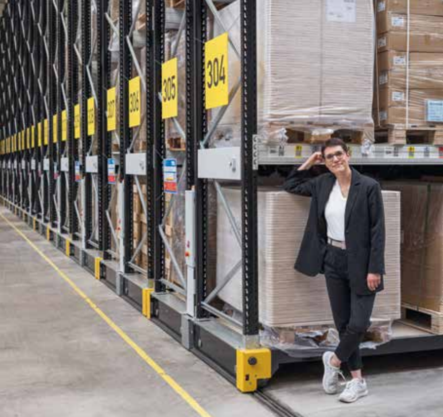
← Die neue Ver-schieberegalanlage im Wagner-Werk 3 mit Platz für 2.600 Paletten
